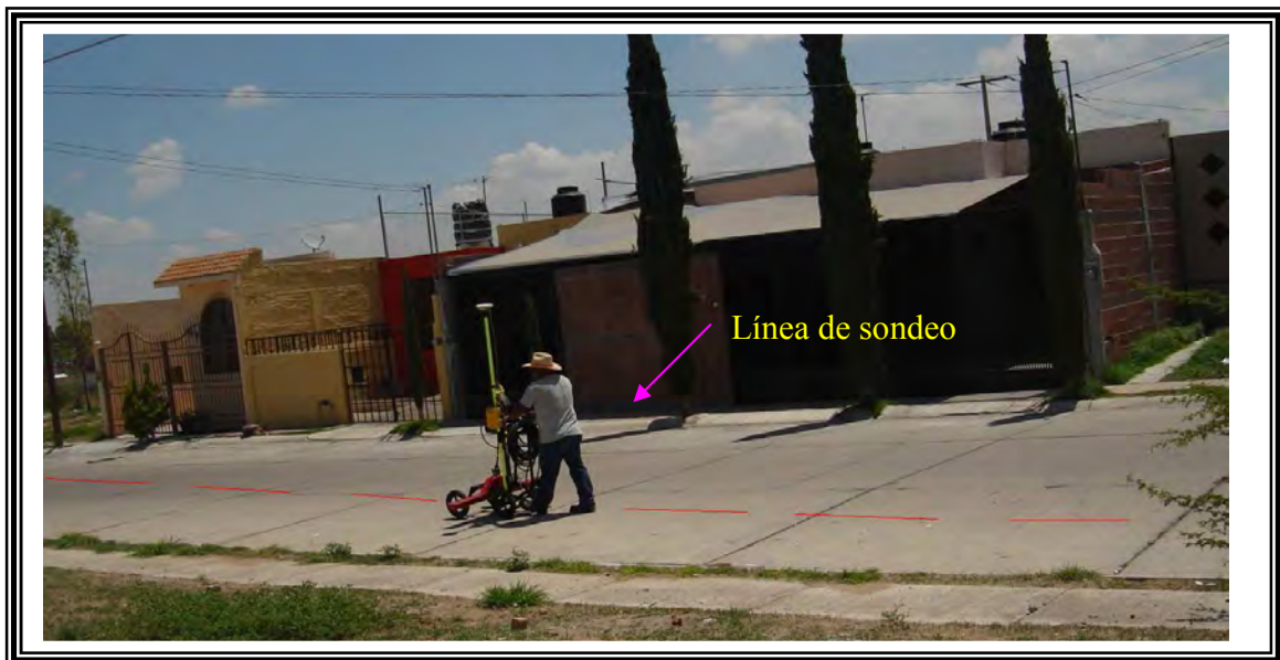
Figura 4.9. Adquisición de los datos GPR con una antena de 70 MHz, en el fraccionamiento Nuevo Jesús María, en la zona conurbana de la Ciudad de Aguascalientes.
