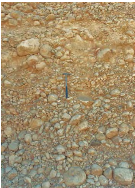
Figura 4.10. Conglomerado en la base de la Formación Agua de Luna en un banco de material en las cercanías de Tepexi de Rodríguez, Pue. Observe la granulometría de los clastos de caliza y el escaso grado de litificación del estrato. Longitud del martillo 405 mm.
