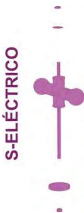
El Sistema del Tambor es el que le da la vista y cuerpo a la lámpara. Se conforma de 2 aros de aluminio, envueltos por un estireno y todo ello cubierto por la tela del color que sea requerida.
