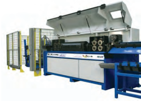
Arriba Máquina trefiladora. El alambre pasa por una serie de rodillos que lo enderezan.
