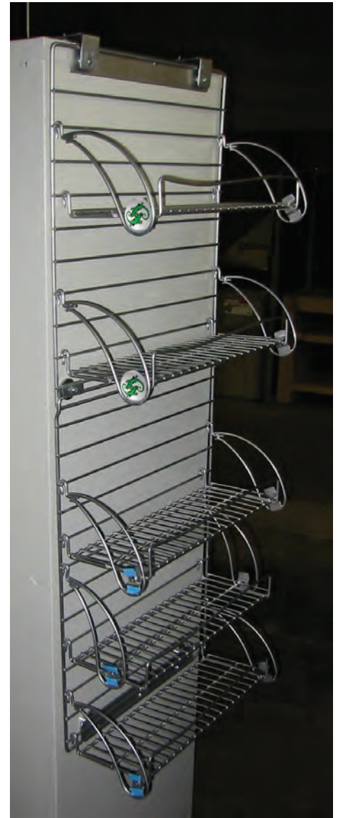
Vista del exhibidor sin producto antes de la prueba de carga. El exhibidor debía resistir por lo menos 40 kilos de carga.
