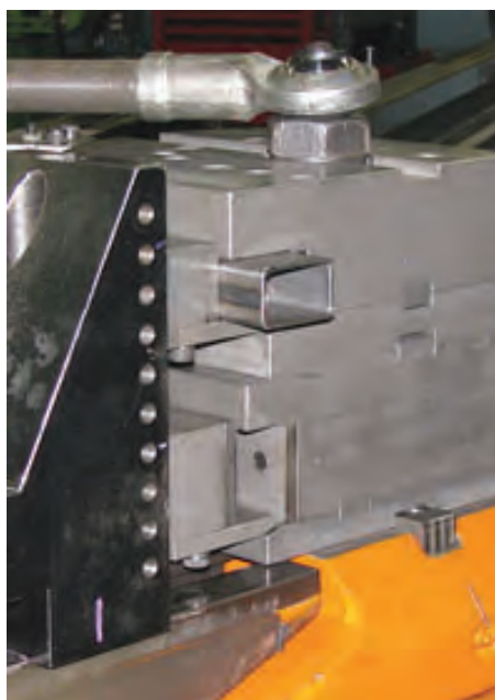
5 La abrazadera de liberación tiene una hoja atornillada a la parte inferior de los dados de sujeción y de presión.
