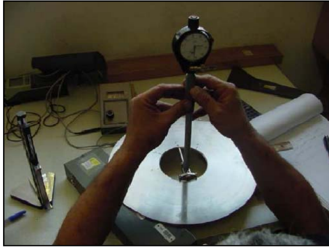
Fig. 3.10 Medición del diámetro de orificio.
