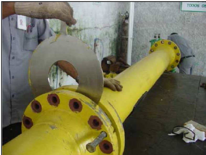
Fig. 3.30 Remoción de placa de orificio en brida.
