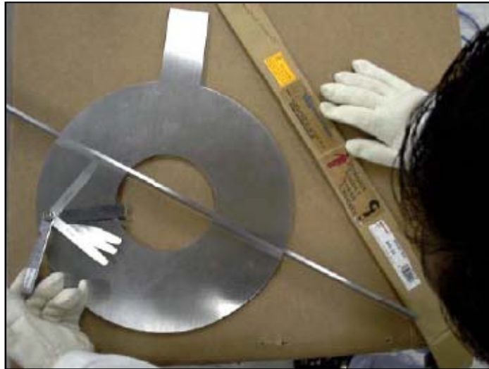
Fig. 3.7 Medición de desviación de planitud.
