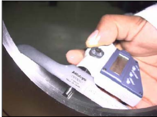
Fig. 3.11 Medición del espesor del orificio de la placa.
