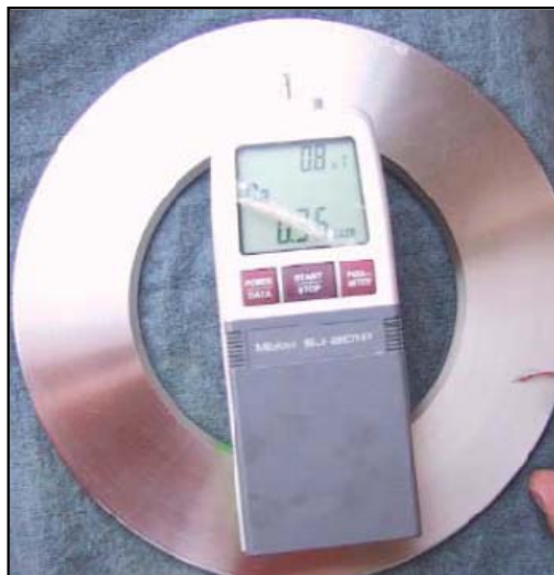
Fig. 3.8 Medición de rugosidad.
