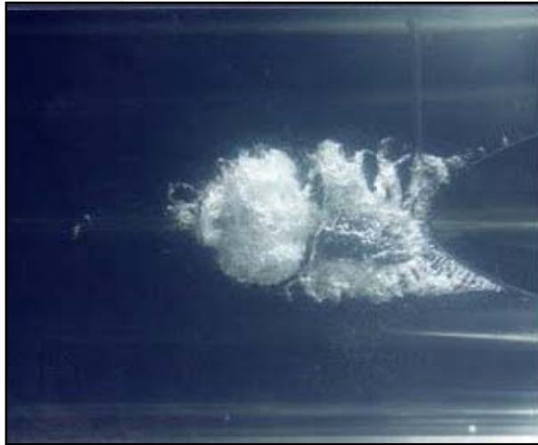
Fig. 1.21 Cavitación en una tubería.
