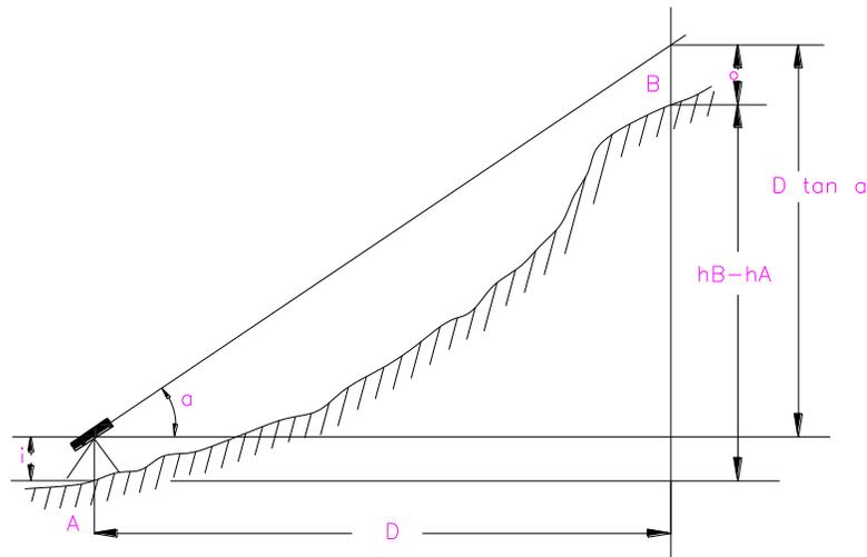
Fig. 4 Nivelación trigonométrica
