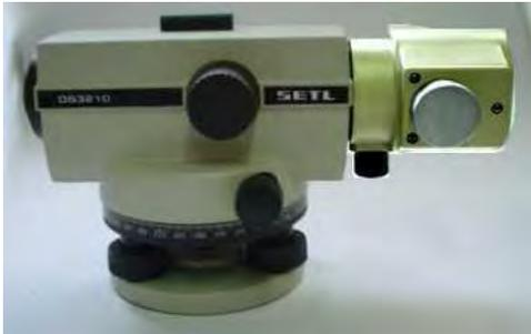
Nivel automático con placa planoparalela
