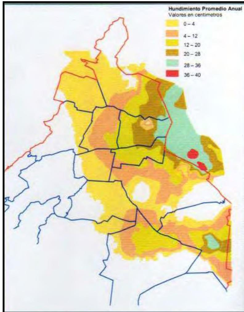
Fig. 26 Mapa de la Configuración de los Hundimientos
