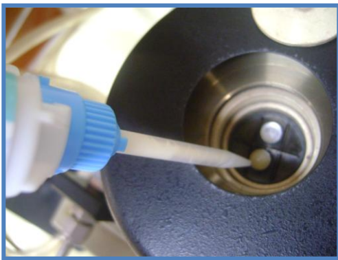
Figura 18. Colocación de resina bis-acrítica. (Fuente propia)
