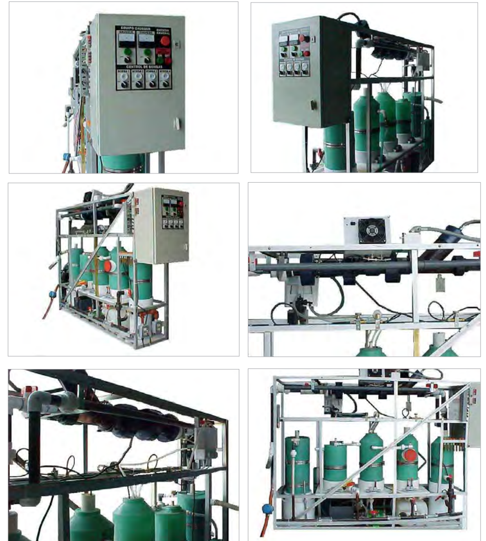
Fig. 9.2 Vistas de la planta de Tratamiento móvil Gausser
