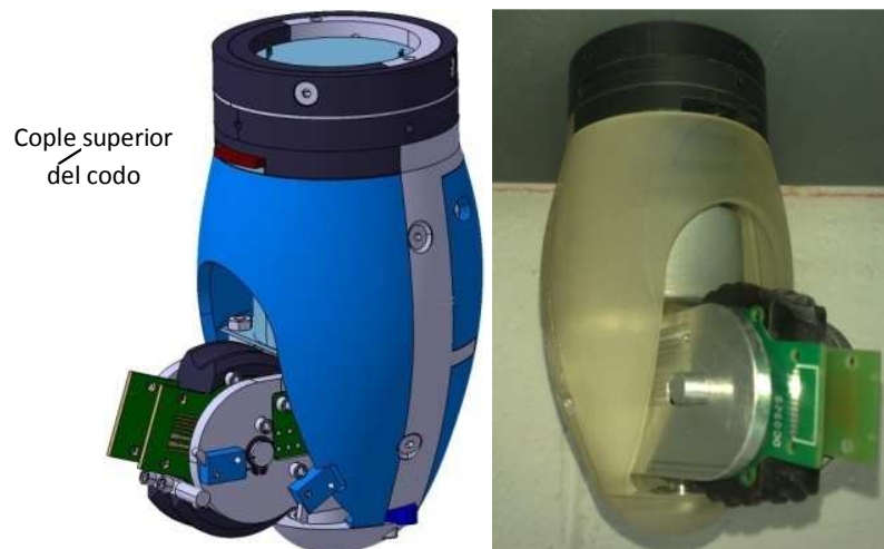
Fig. 2.5 Codo automático desarrollado en Pro/Bionics. Fuente: Pro/Bionics.
