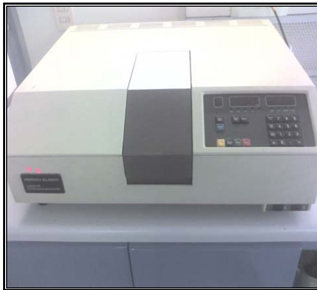
Figura 3.7 Espectrofotómetro Perkin-Elmer Lambda 3B UV/VIS empleado para medir Absorbancia UV a 254 nm.
