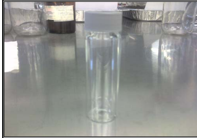
Figura 3.3. Recipiente para la recolección de muestra para el análisis de Trihalometanos.
