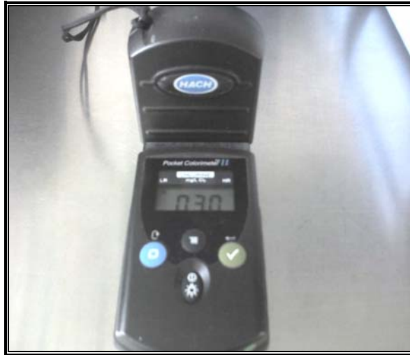
Figura 3.11. Colorímetro HACH empleado para la medición de cloro libre in situ .
