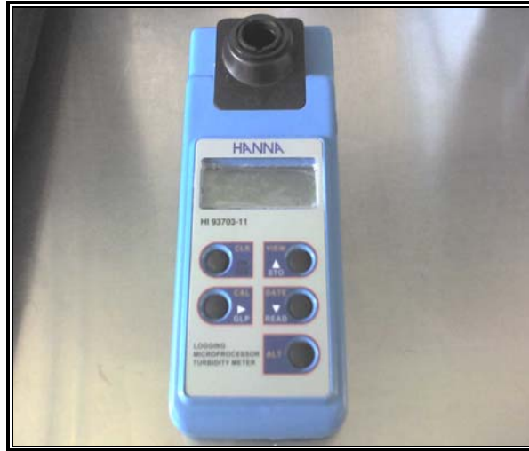
Figura 3.9. Turbidímetro HANNA empleado para la determinación de turbiedad en agua potable.
