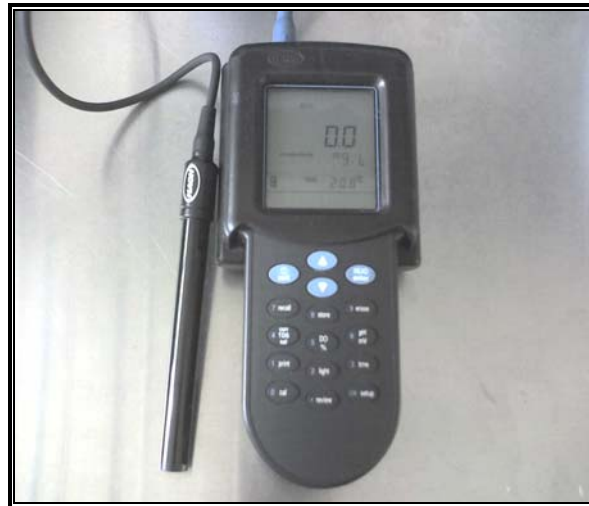
Figura 3.10. Potenciómetro HACH utilizado para los análisis en campo.
