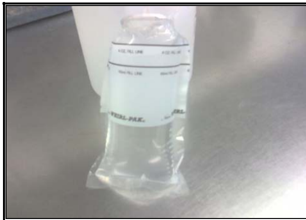
Figura 3.4. Bolsas estériles empleadas para la determinación de Coliformes Totales y Coliformes Fecales
