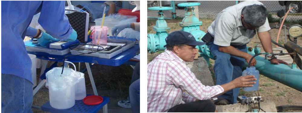
Figura 3.2. Muestreo de aguas subterráneas en el área de estudio y determinación de algunas variables “in situ”.
