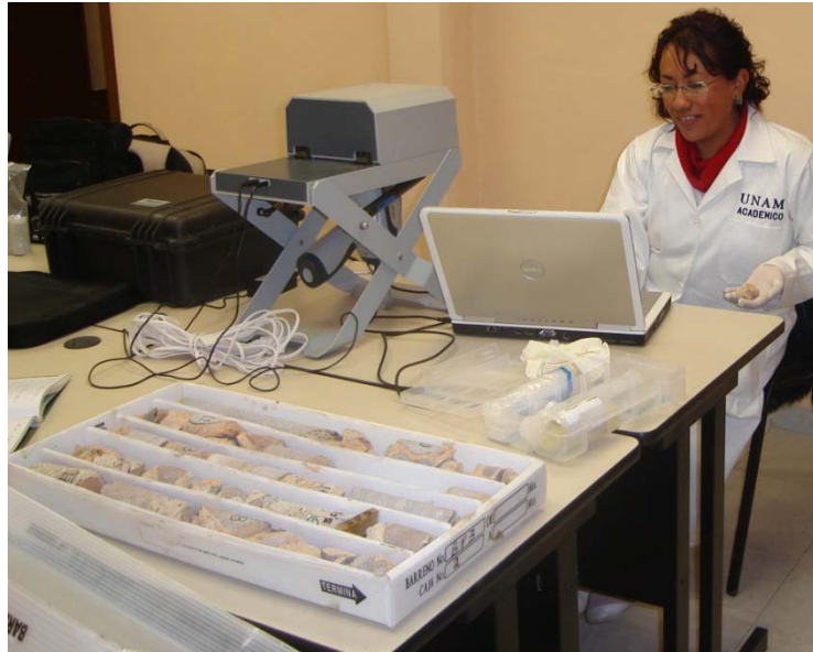
Figura 3.7. Preparación del equipo antes de tomar las lecturas de As y Pb que presentaron los núcleos de los barrenos perforados.
