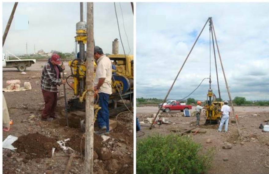
Figura 3.5. Perforación de pozos para la realización de pruebas de permeabilidad y toma de muestras para análisis químicos.
