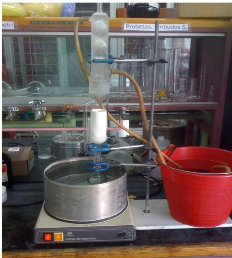
Fig. 8 Equipo de Soxhlet
