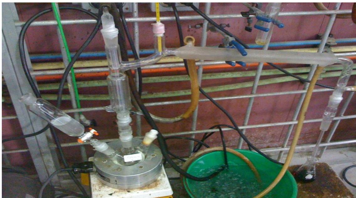
**Fig. 7** Equipo para destilación del amoníaco
