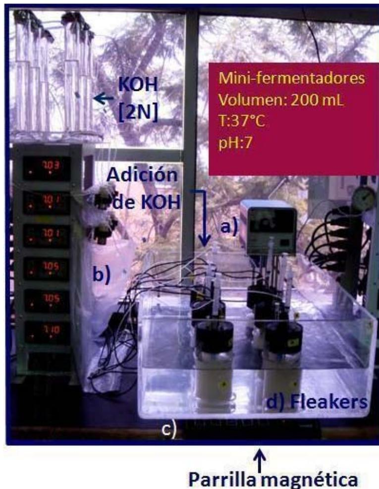
**Figura 6.** Sistema de mini-fermentadores.
