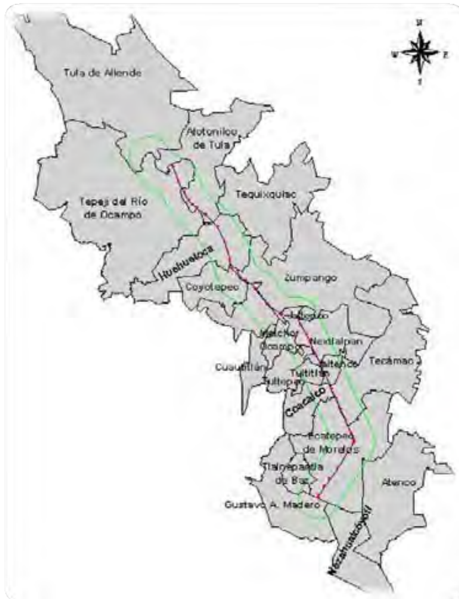
FIGURA 3.1.1. TRAYECTO DEL TÚNEL EMISOR ORIENTE
