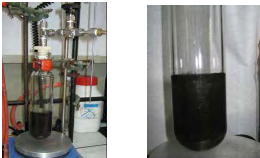
Figura 5.3 Nanopartículas de paladio.
