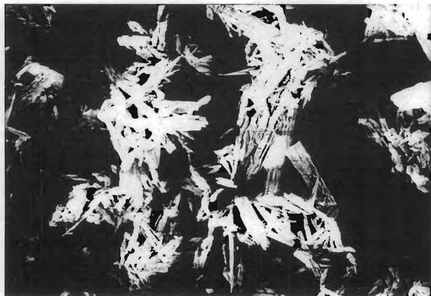
Figura 41. Microfotografía de Dihidrato de Lisinopril (Lote 2) a 450X.
