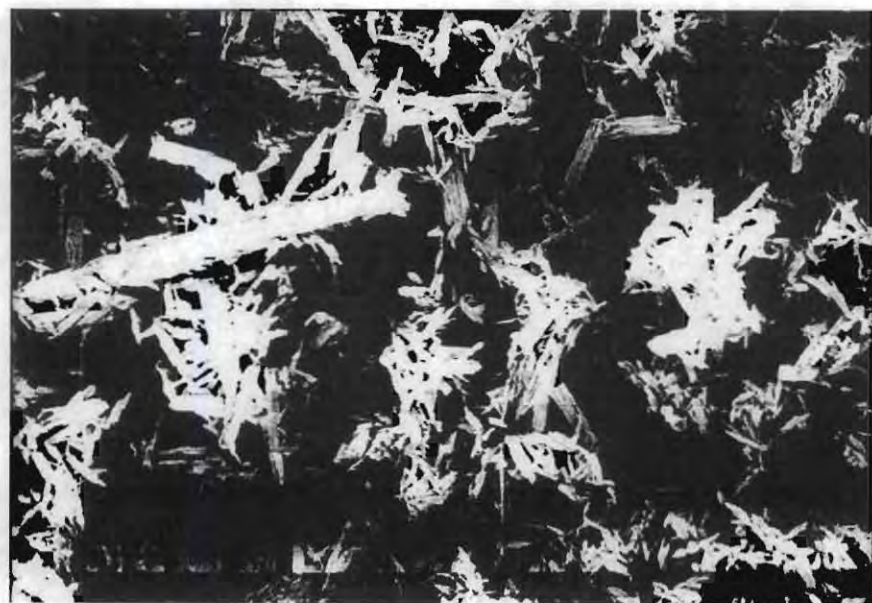
Figura 39. Microfotografía de Dihidrato de Lisinopril (Lote 2) a 200X.
