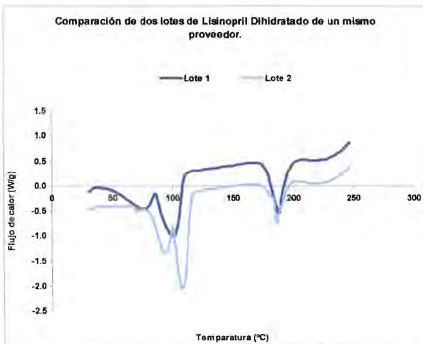
Figura 31. Termogramas de Dihidrato de Lisinopril obtenidos por DSC.
