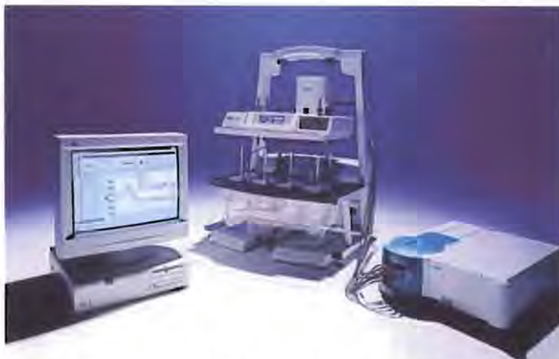
Figura. 22. Estación de disolución con sistema de fibra óptica. www.hansonresearch.com
