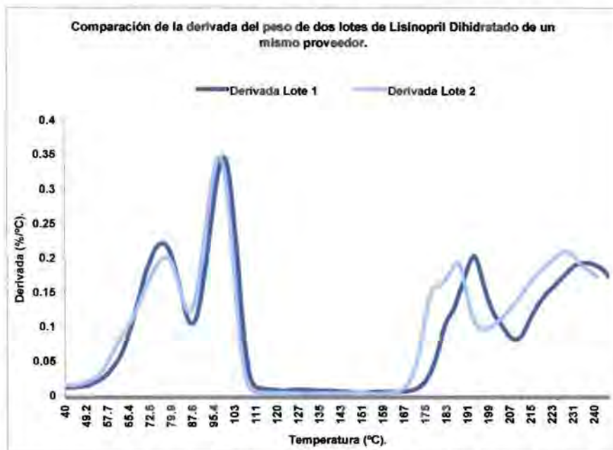
Figura 33. Derivada de los termogramas de Dihidrato de Lisinopril obtenidos por TGA.
