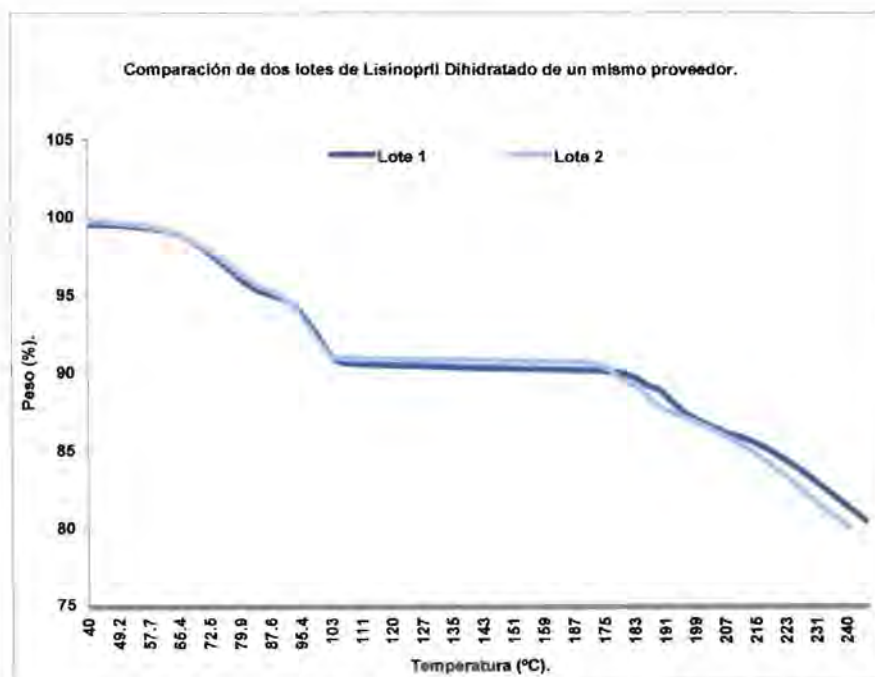
Figura 32. Termogramas de Dihidrato de Lisinopril obtenidos por TGA.
