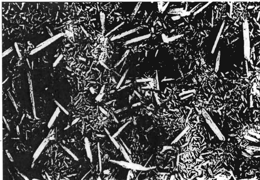
Figura 36. Microfotografía de Dihidrato de Lisinopril (Lote 1) a 100X.
