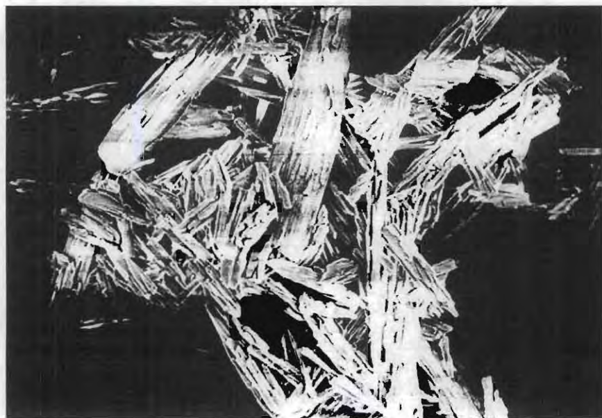
Figura 43. Microfotografía de Dihidrato de Lisinopril (Lote 2) a 1000X ó 1K.
