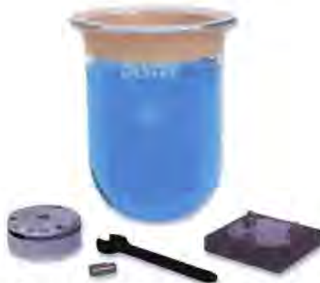
Figura 21. Aparato de Wood o aparato de disco giratorio.
