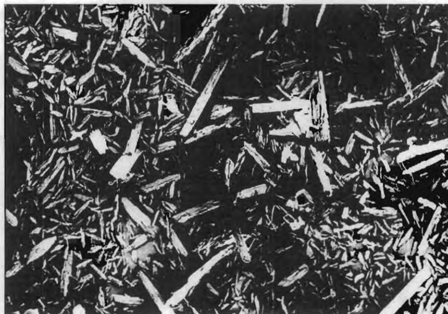
Figura 38. Microfotografía de Dihidrato de Lisinopril (Lote 1) a 200X.
