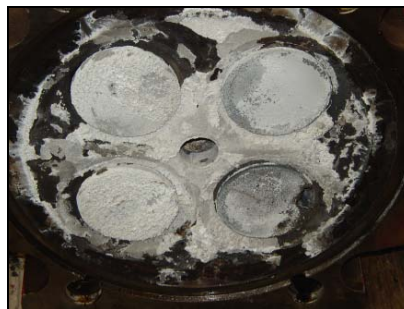
Figura 4.1. Contaminación de los pistones de un motor por silicio (Appels y col., 2008)
