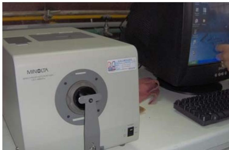
**Figura 5.3** Colorímetro Minolta CM – 3600d
