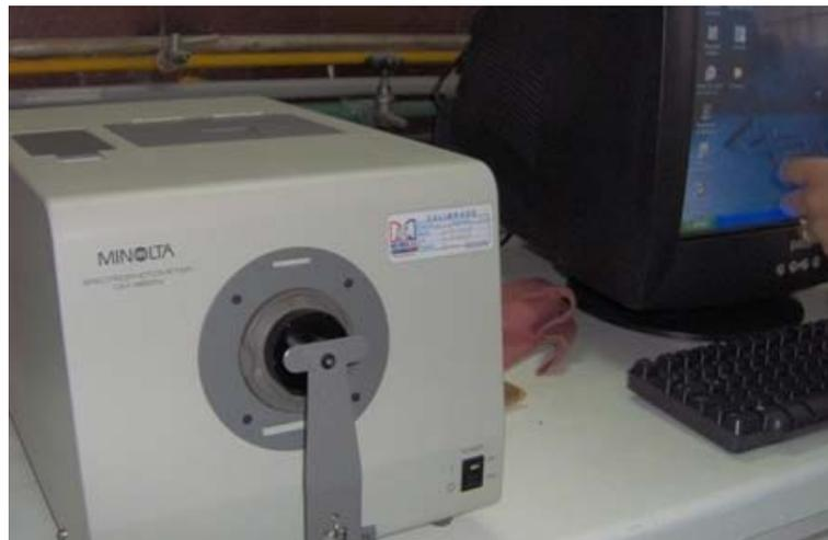
**Figura 5.3** Colorímetro Minolta CM – 3600d
