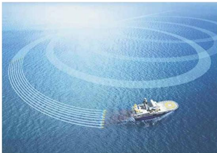
Figura 3.2 Esquema de levantamiento sísmico vertical (Tomado de Buia, 2006).
