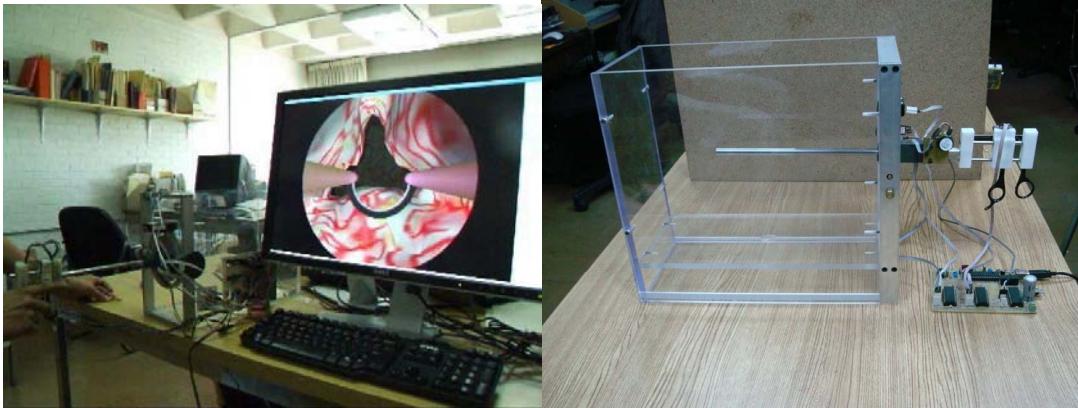
Figura 2.12 Simulador de Realidad Virtual de RTUP completo del Grupo de Análisis de Imágenes y Visualización del CCADET. El bloque de gráficos consiste en el despliegue de la escena 3D con OpenGL en un monitor estándar de computadora.
