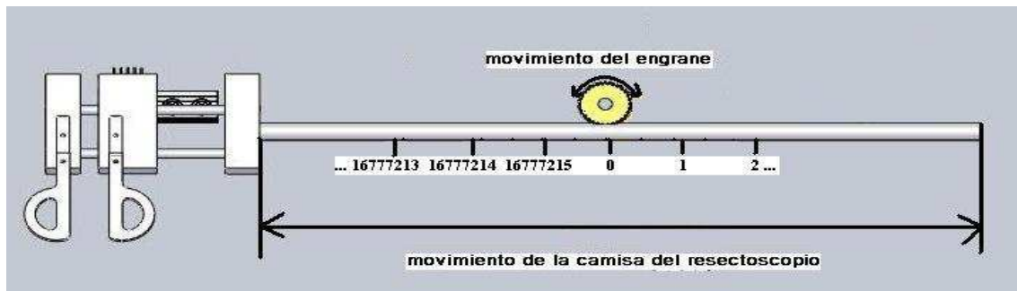
Figura 3.17 Lectura de contador de pulsos LS7266R1 de los pulsos generados por el codificador óptico (Nota: La distancia entre cada pulso están de fuera de escala)
