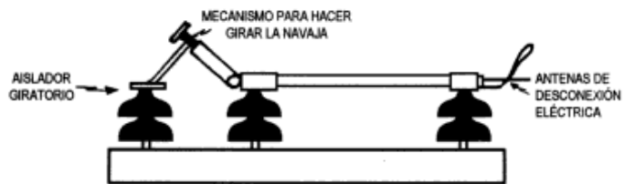
Figura 2.71. Cuchillas de apertura vertical para operar sin carga.
