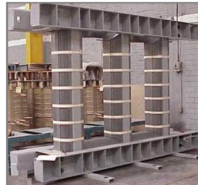
Figura 2.2. Núcleo de transformador de potencia
