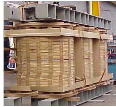
Figura 2.3. Devanado de baja tensión de transformador de potencia. Figura 2.4. Devanado de alta tensión de transformador de potencia.
