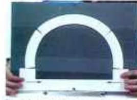
Empuje horizontal (parte de apoyo).
