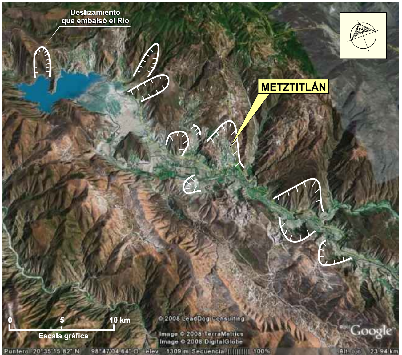
Fig. 9.1.11 Deslizamientos en la barranca
