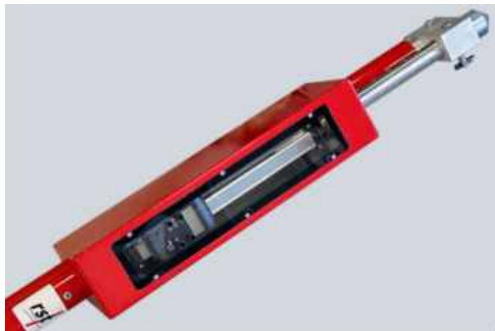
Fig. D.9 Medición de convergencias con sensor electrónico
