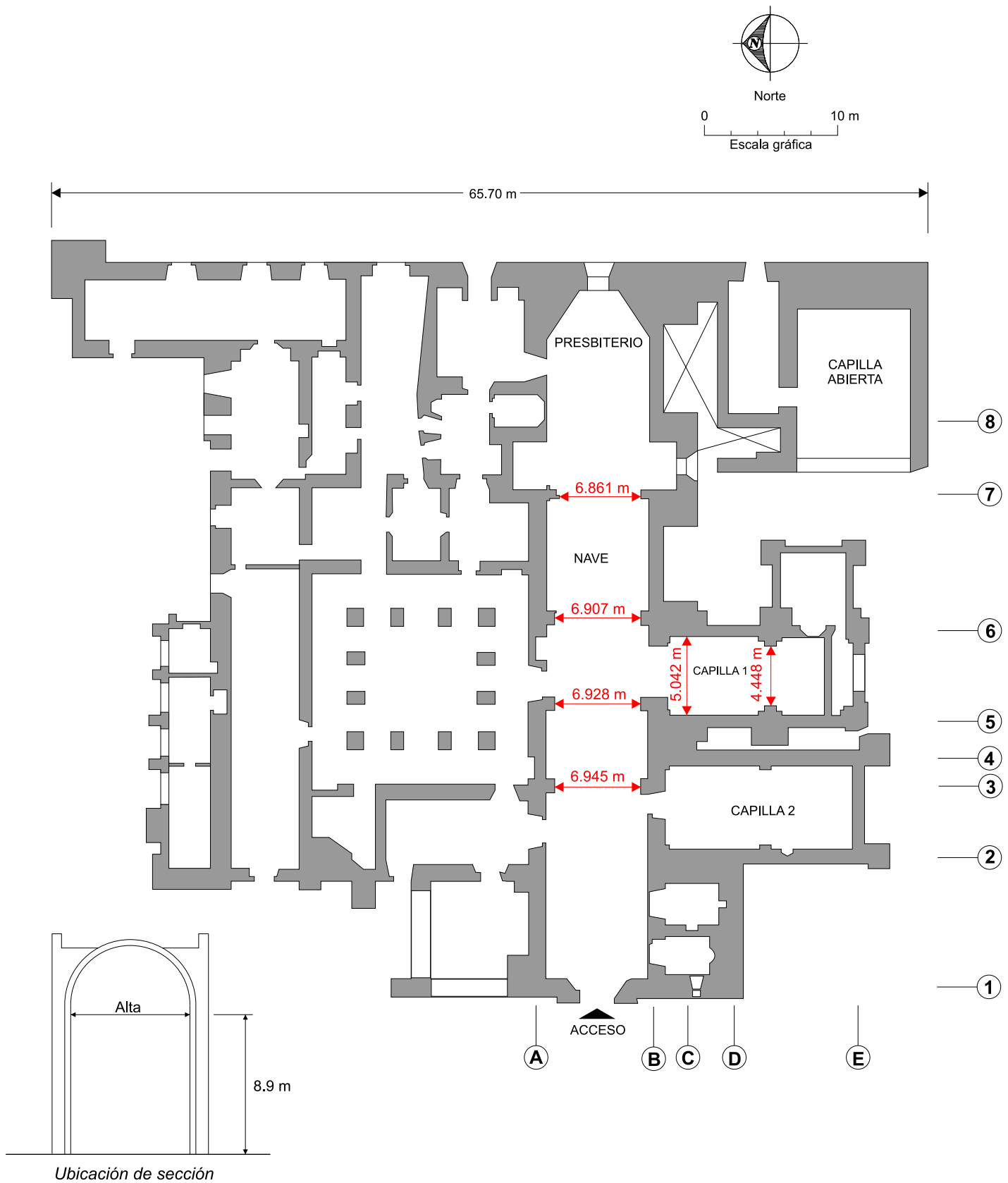
Fig. 12.1.5 Primera medición de distancias entre pilastras, sección alta, 13 de septiembre de 2000
