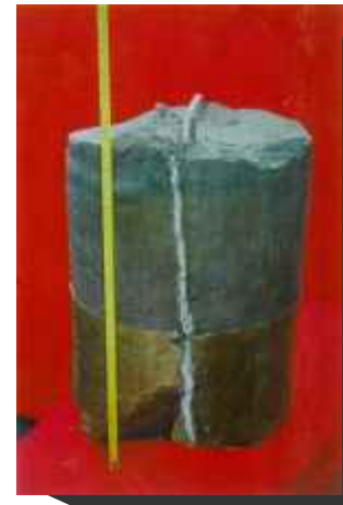
Muestra de arcilla inyectada con mortero, recuperada a la profundidad de 12.5 a 13.0 m, en la torre surponiente
