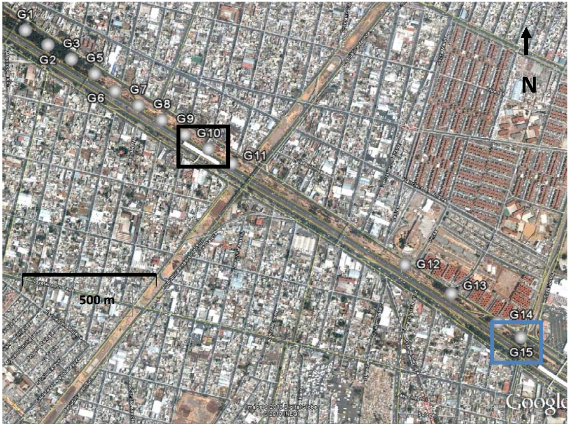
Figura 4.5 Localización de los puntos de medición con los sensores de velocidad Guralp CGM 40T, indicándolos con puntos grises. El recuadro negro corresponde al área mostrada en la figura 4.6 y el recuadro azul corresponde a la mostrada en la figura 4.7.
