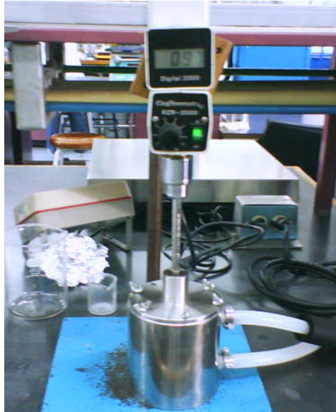
Figura 2.2. Tanque enchaquetado de acero inoxidable con agitación mecánica utilizado para preparar las papillas.
