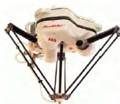
Figura 1.1b robot manipulador paralelo delta
