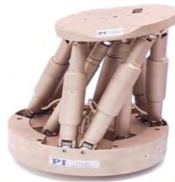
Figura 1.2c Robot paralelo espacial(Bonev 2002)
