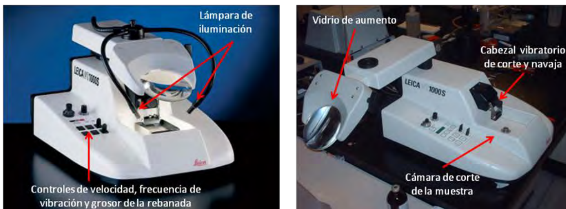
Fig. 6.1 Microtopo de navaja vibrante (VT 1000 S©, Leica Microsystems©, Wetzlar, Germany, se muestran sus principales componentes)
