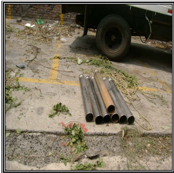
SE OBSERVAN LOS TUBOS DE PARED DELGADA QUE SE UTILIZAN PARA EL MUESTREO.
