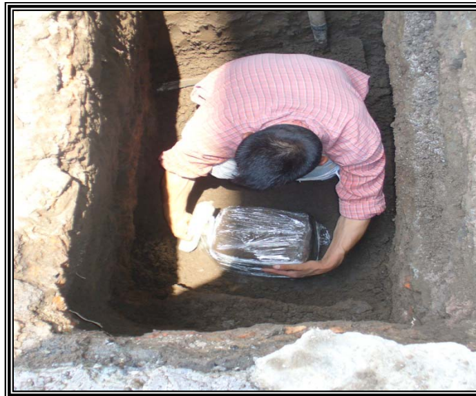
OBTENCIÓN DE LA MUESTRA CÚBICA
