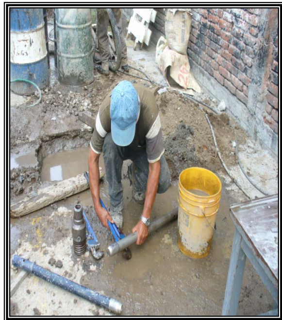
SE OBSERVA EL EQUIPO Y LA HERRAMIENTA PARA EL MÉTODO DE PENETRACIÓN ESTÁNDAR
