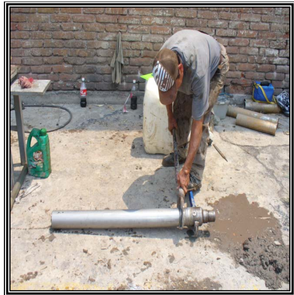
SE OBSERVAN LOS TUBOS DE PARED DELGADA QUE SE UTILIZAN PARA EL MUESTREO.
