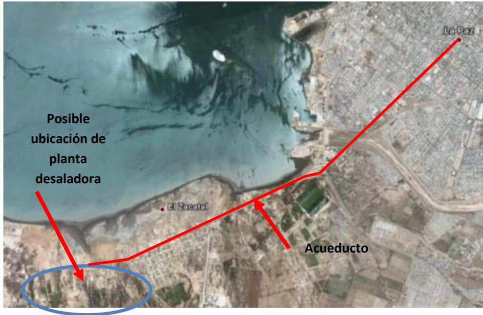
Figura 11: Acueducto de impulsión del agua producto
