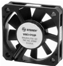
Figura 66. Imagen del ventilador que se colocó. Ventilador de plástico marca Steren de 12 volts de corriente directa, 60 mA, 700 mW de potencia, de 7000 a 10000 RPM, 25 dBA de ruido y dimensiones de 40 x 40 x 10 mm. Fuente: http://www.steren.com.mx/catalogo/buscador.asp
