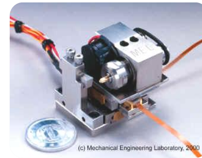
Figura 14. Microtorno desarrollado por el Laboratorio de Ingeniería Mecánica (MEL por sus siglas en Inglés) en Japón.
