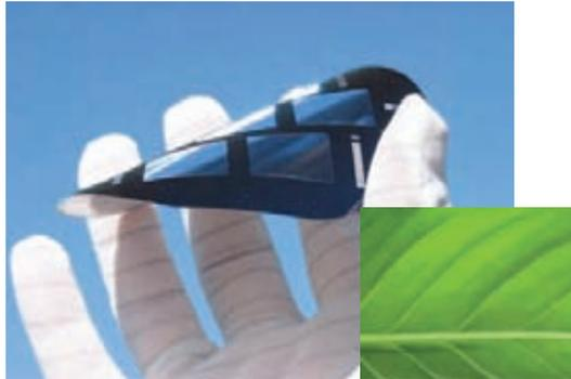
Imagen 83. Celda solar flexible. Por NASA
