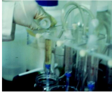
Figura 38. Equipo de filtrado con columnas aflatest
