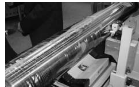
Esta es una máquina calcográfica cilíndrica.
