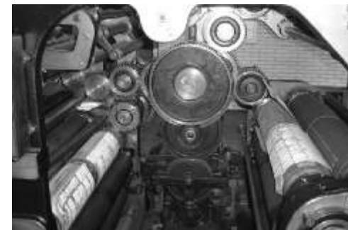
Máquina rotativa llamada así porque el papel se imprime con la presión de cilindros.
