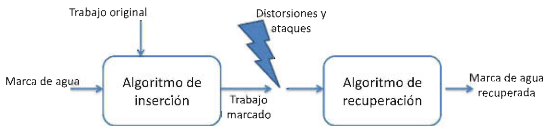
Figura 2.2 Sistema de marcado de agua.
