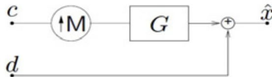
Figura 3.15 Síntesis Laplaciana. \hat{x} es la imagen reconstruida [17].
