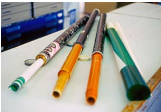
Tipos y colores de película. Las películas color verde y ámbar son de las más usadas actualmente.
