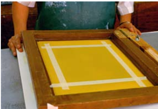
Se delimita el área a utilizar con masking tape.
