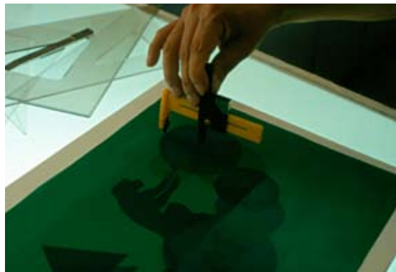
Cortar la película según el diseño establecido, utilizando las herramientas adecuadas.
