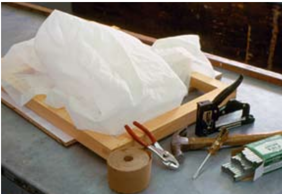
Material para tensar la malla al marco.
