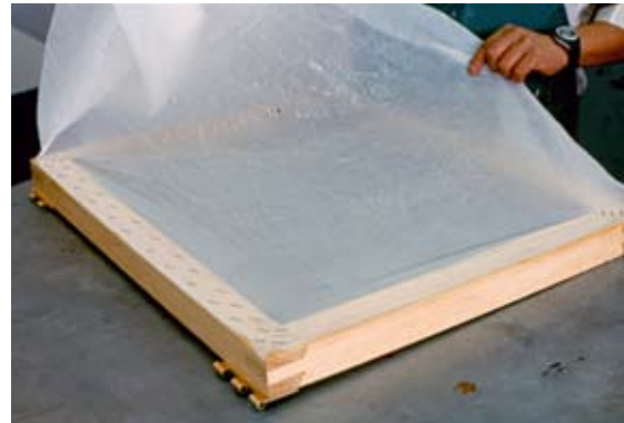
Una vez engrapado un lado, se tensa la malla hacia la siguiente esquina y se engrapa.
