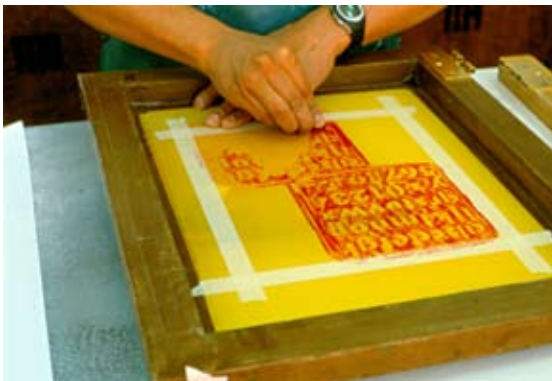
Empezar a frotar con el crayón, directamente a la malla con las texturas debajo.
