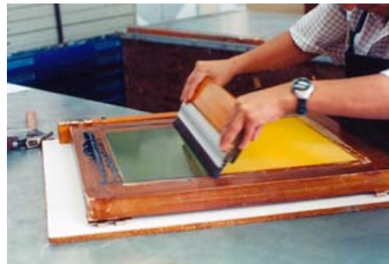
Distribuir con el rasero, de manera uniforme, la emulsión fotográfica en toda la superficie de la pantalla.
