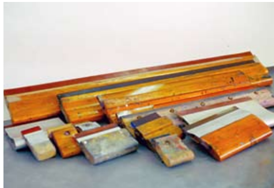
Raseros de diferentes tamaños, según la necesidad de impresión.
