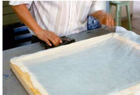
Se tensa la malla hacia alguna de las siguientes esquinas y se engrapa.
