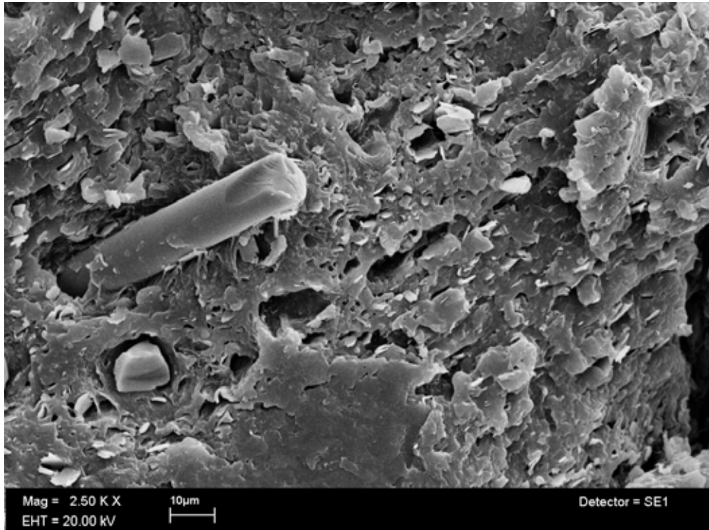
Fig. 27 Polipropileno reciclado con 2 phr de Arcilla, 30 phr de FV y 5 phr de Aditivo
