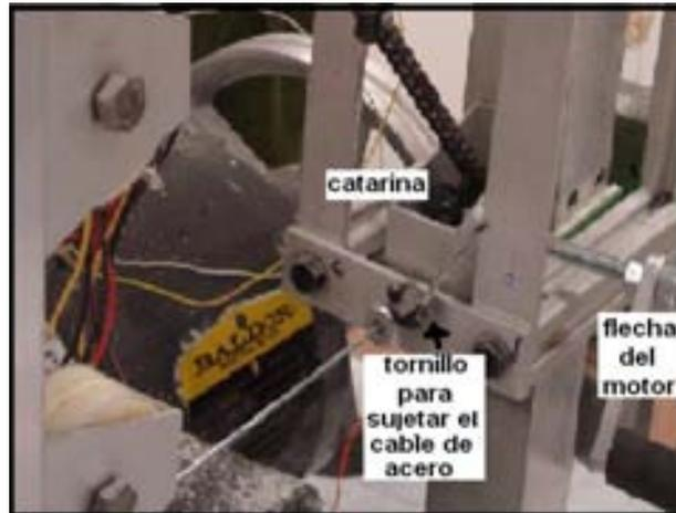
Fotografía 3.5. *Partes del sistema para trasladar la mazorca.*
