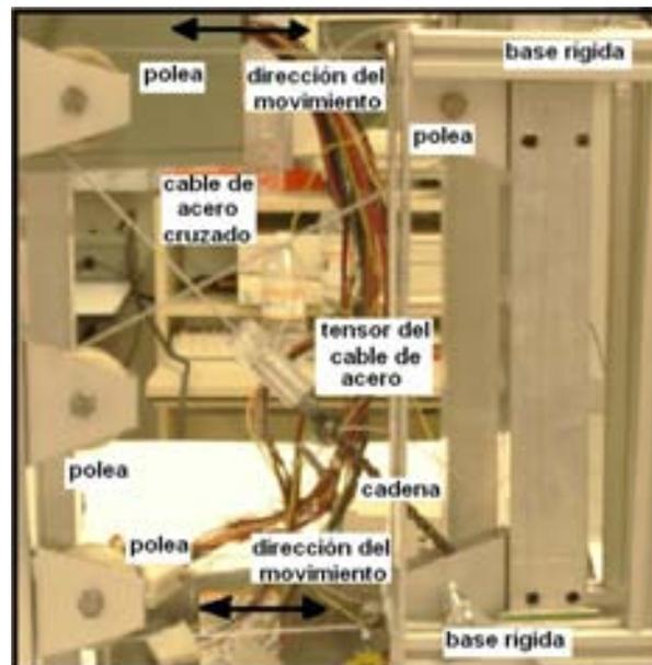
Fotografía 3.4. *Partes del sistema para traslada la mazorca.*
