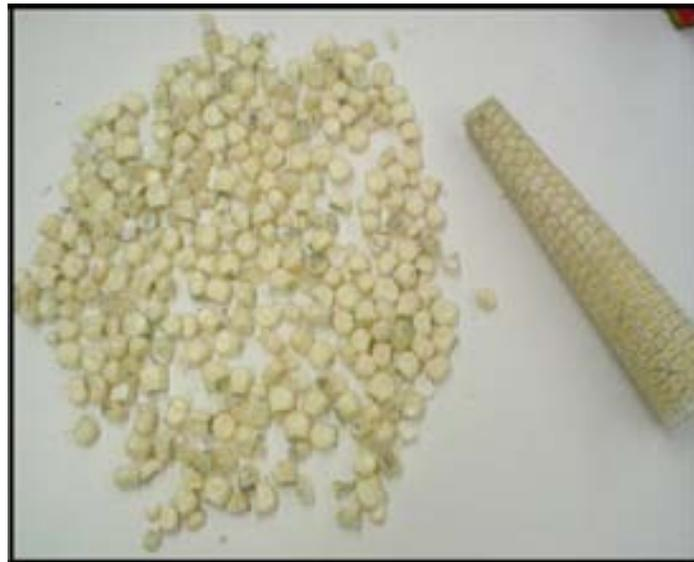
Fotografía 4.11. *Grano y olote cortado en un 100 % de forma correcta.*
