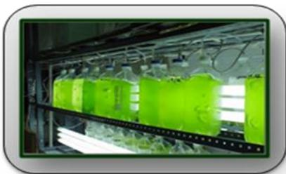
La cepa de *S. acutus* se obtuvo de la Universidad de Texas registrada con la clave 72. Su cultivo masivo se realizó en botellas de plástico de 2 lts de capacidad con medio Bold (Pavón-Meza, 1993) (Anexo III). Se expuso a iluminación continua, aireación con un tubo de vidrio conectado a flujo de aire (con la finalidad de evitar sedimentación
