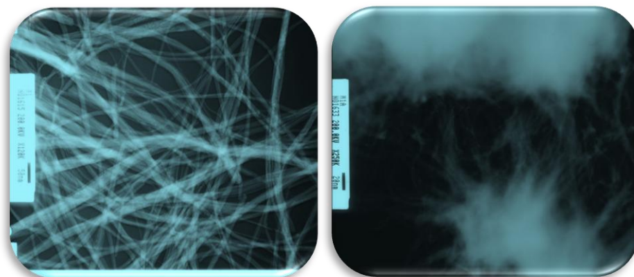
Figura 43. Imágenes de TEM a un tiempo de reacción de 10 horas, de los sistemas: (a) WCl_6 /etanol, (b) WCl_6 /etanol/ácido acético.
