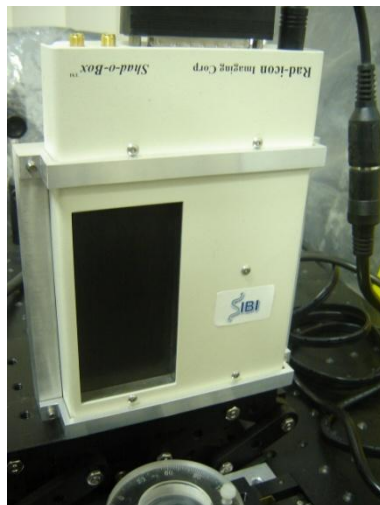
Figura 2.2. Detector de panel plano Shad-o-Box con pantalla centelladora de GADOX, área efectiva de 10 \times 5 \text{ cm}^2 .
