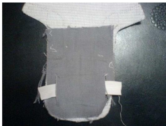
Una vez seleccionados los materiales se prepara el diseño o modelo que se quiere fabricar. Para ello se ha de confeccionar el patronaje de todas las piezas, que servirá para cortar la piel de empeine con las formas y medidas precisas.
