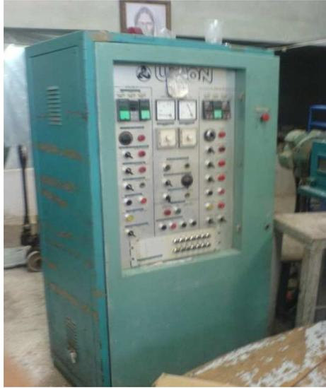
2. Tanto los rines, las hormas, las plantillas y la puntera al encenderse tiene su propio tablero en la maquina para que este trabaje acorde con el empleado que este laborando en ese momento, el tablero consta de tipo manual o automático, que por lo regular siempre es automático para que el empleado tenga la capacidad y la destreza de acoplarse al movimiento o al trabajo de la maquina.
