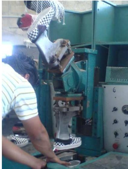
6. Después, la máquina calienta, mezcla e inyecta la mezcla de PVC en la cavidad del molde en forma automática y se pueda poner la primera parte de la inyección de color blanco que es la “horma” pasa al segundo inyector que es el de color,
