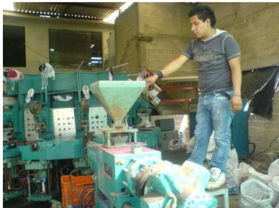
5. Seguidamente se sujetan los moldes en la máquina de inyección directa para que este al poder bajarse se puedan inyectar la suela.
