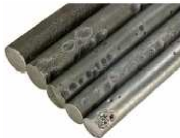
Figura 4.23 Corrosión influenciada microbiológicamente [20] .
