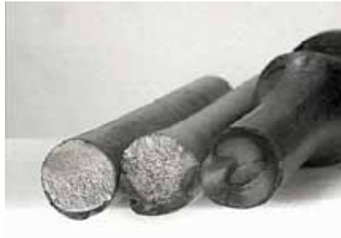
Figura 2.27 Falla típica de fatiga [25] .
