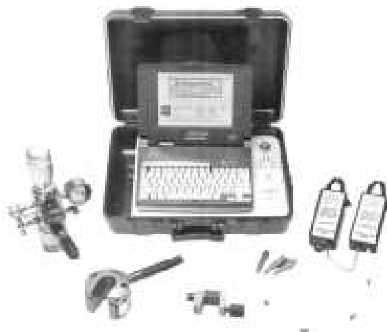
Figura 3.3 Ecómetro digital analizador de pozos [18] .
