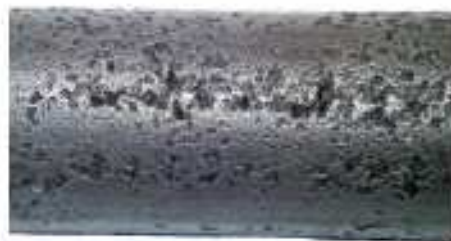
Figura 4.19 Corrosión por cloruros [20] .
