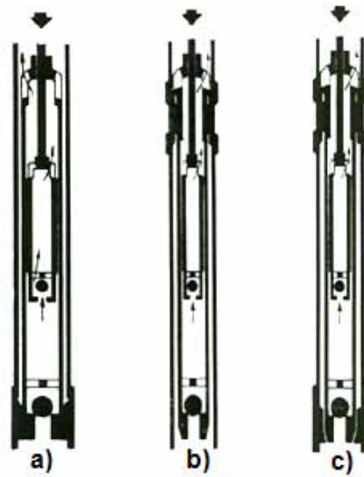
Figura 2.10 Bombas de inserción de barril fijo, de izquierda a derecha: bomba de anclaje inferior, bomba de anclaje superior y bomba de anclaje mixto [4] .
