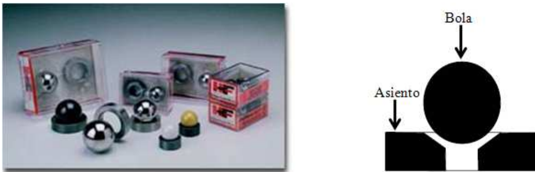
Figura 2.16 Bola y asiento (válvula viajera y válvula de pie) [15] .
