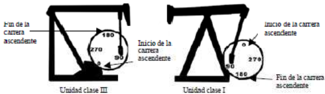
Figura 3 Movimiento de bombeo a los 90^\circ [2].
