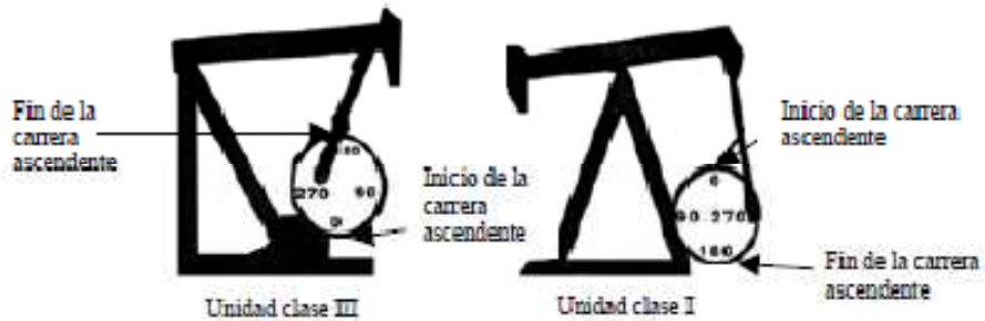
Figura 6 Movimiento de bombeo a los 270° [2].
