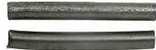
Figura 4.17 Falla de la varilla por flexión [20] .
