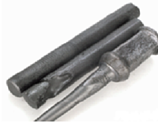
Figura 2.24 Falla por efecto de corrosión [25] .
