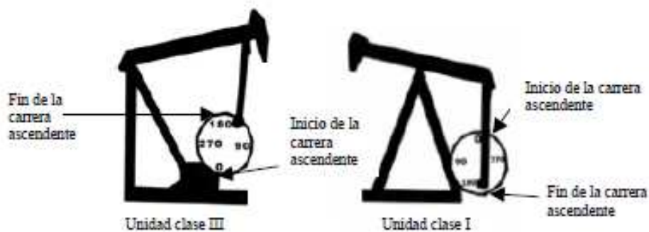
Figura 4 Movimiento de bombeo a los 180^\circ [2].
