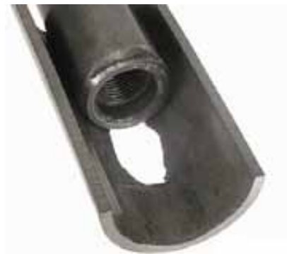
Figura 2.26 Falla típica por desgaste de la tubería causado por el contacto entre la tubería y la varilla [25] .
