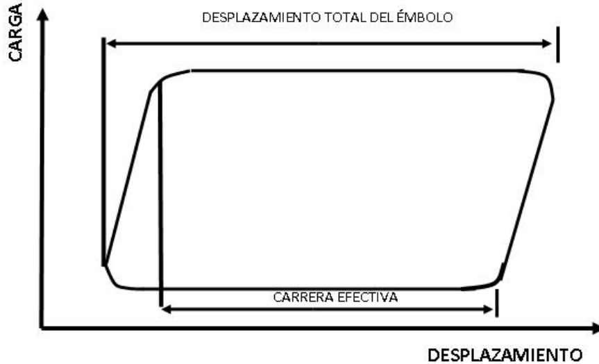
Figura 4.5 Gráfica de la bomba indicando tubería desanclada [2].
