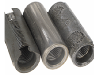
Figura 2.25 Falla del acoplador por abolladura [25] .
