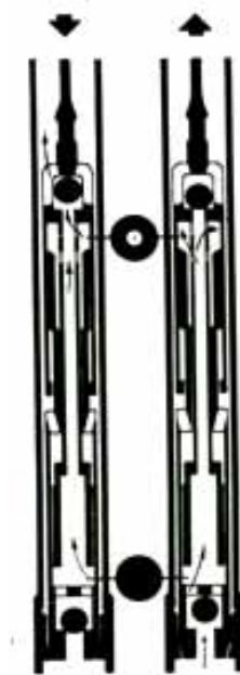
Figura 2.14 Bomba de doble succión o arreglo en paralelo [4] .
