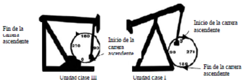
Figura 2 Inicio del movimiento ascendente [2].
