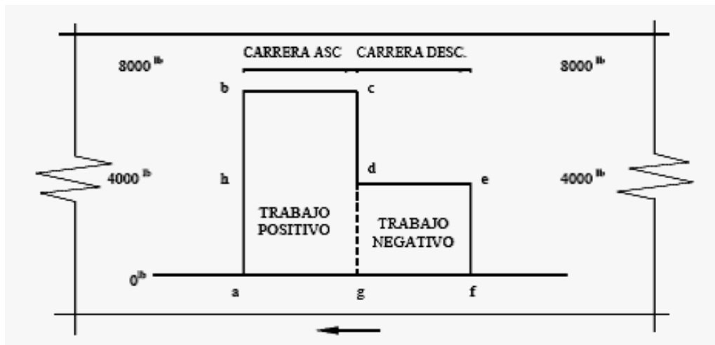
Figura 3.9 Patrón de cargas en la varilla pulida [18] .
