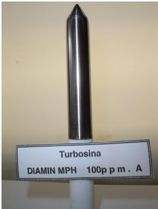
Fig. 40. Cupón de corrosión del producto DIAMIN MPH con calificación de B ++ .
