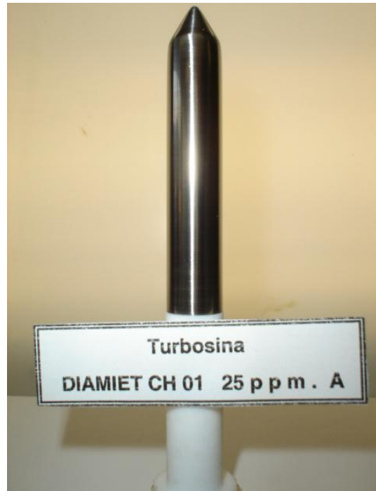
Fig. 39. Cupón de corrosión del producto DIAMIET CH01 con calificación de A.
