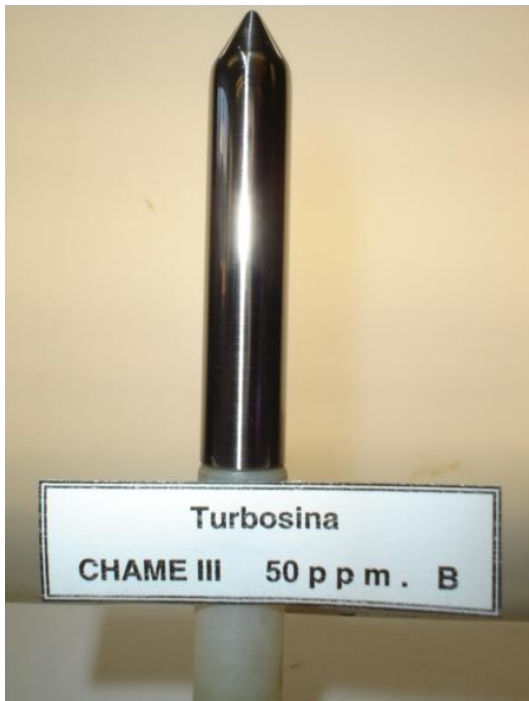
Fig. 36. Cupón de corrosión del producto CHAME con calificación de B ++
