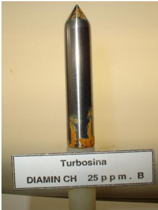
Fig. 38. Cupón de corrosión del producto DIAMIN CH con calificación de B + .
