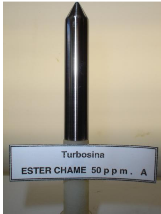
Fig. 37. Cupón de corrosión del producto ESTER DE CHAME con calificación de B ++ .
