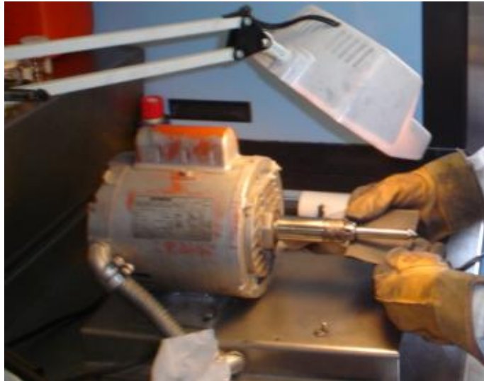
Fig. 27. Pulido de los cupones de corrosión.
