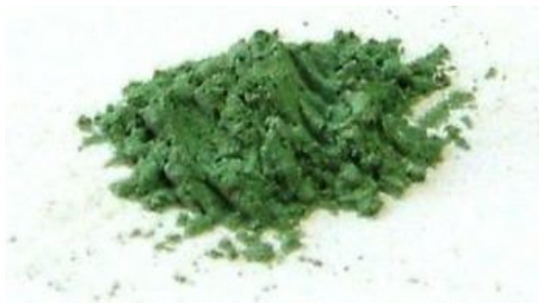
Figura 3.8 Color final que muestra el pigmento Zr(Ti_{0.9}Co_{0.1})O_4 después de las pruebas a diferentes temperaturas.
