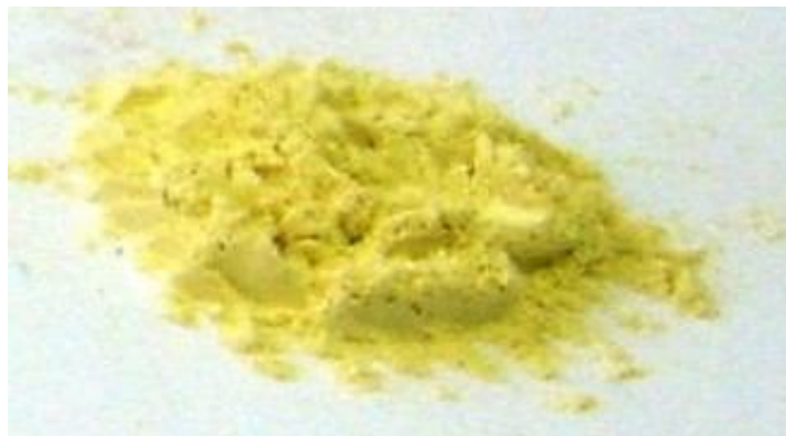
Figura 3.13 Color que muestra el pigmento Zr(Ti_{0.9}Ni_{0.1})O_4 después de las pruebas a diferentes temperaturas.
