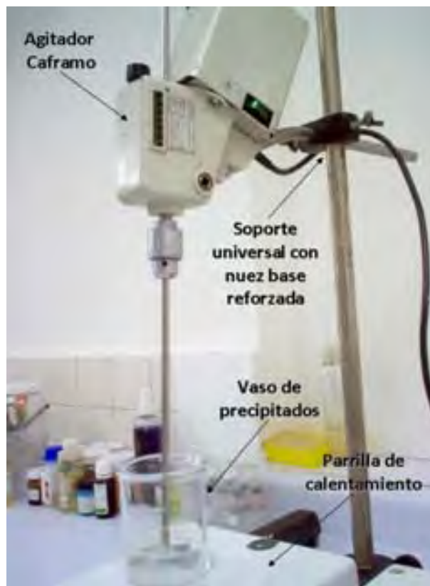
Figura 15. Montaje experimental con agitador caframo para la preparación de gel ondulado en frío
