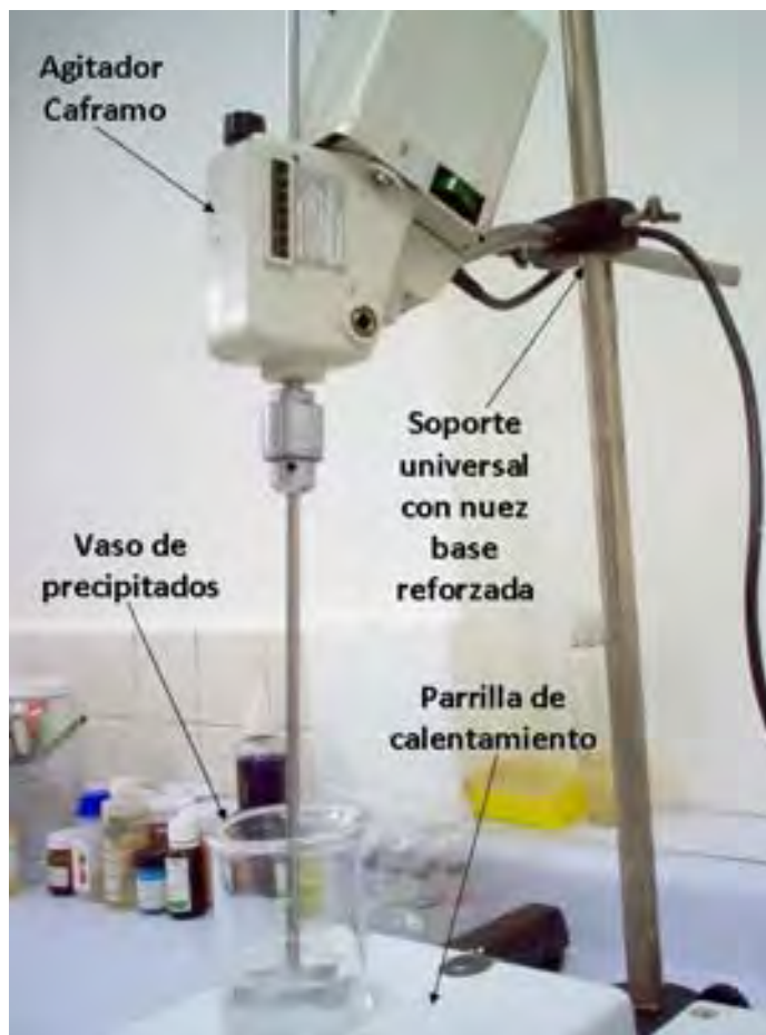
Figura 16. Montaje experimental con agitador caframo para la preparación de Jabón líquido
