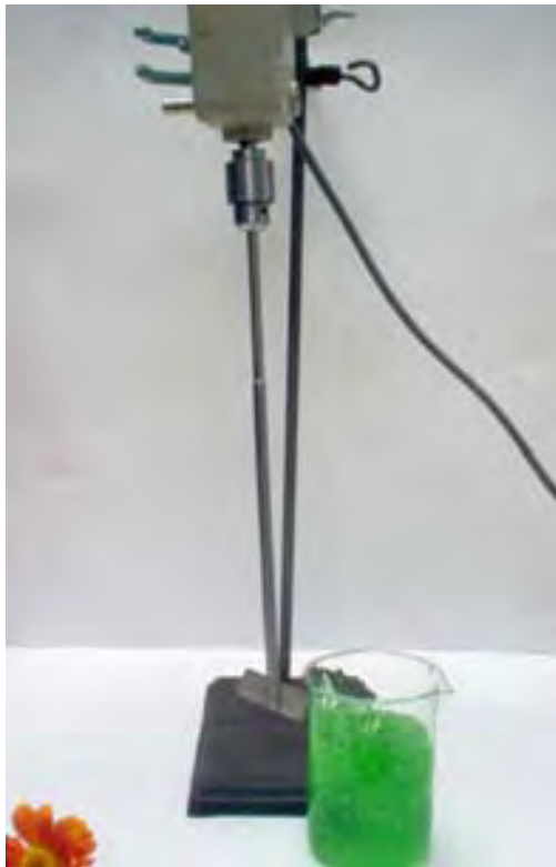
Figura 14. Montaje experimental de la terminación del gel
