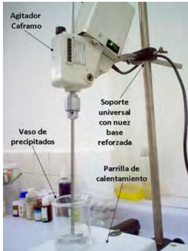
Figura 18. Montaje experimental con agitador caframo para la preparación de una crema para cabello.
