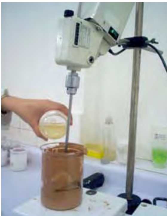
Figura 12. Montaje experimental con agitador caframo de la terminación de un maquillaje.
