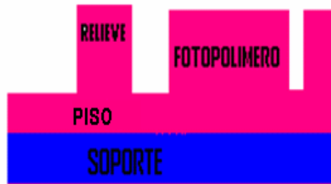
Fig.1.15 Zonas que componen una plancha flexográfica
