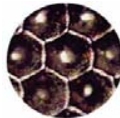
Fig. 1.13 Grabado Hexagonal a 30° visto microscópicamente.
