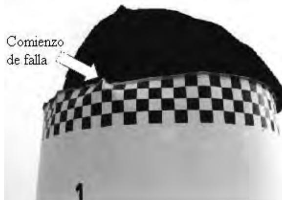
**Fig. 3.1 Falla en la Unión Techo-Envolvente**
