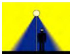
A).- Luminaria eficiente B).- Luminaria Ineficiente C).- Luminaria Ineficiente
