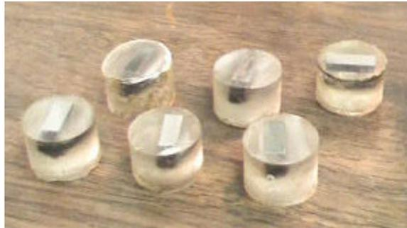
Fig. 23. Probetas montadas en Resina.
