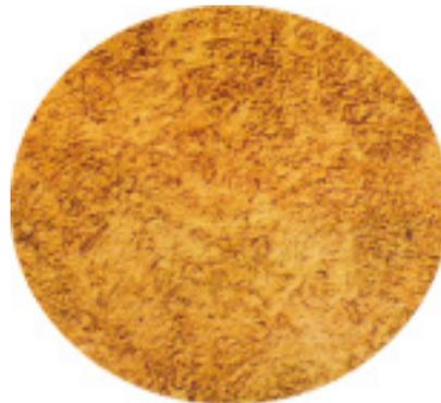
Fig. 5. Fotografía con 400x, de 0.45% de carbono, calentado a 800 °C y enfriado en horno.
