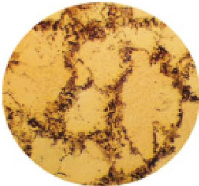
Fig. 4. Fotografía con 400x, acero a 0.45% de carbono, Calentado a 1000 °C y enfriado en horno.
