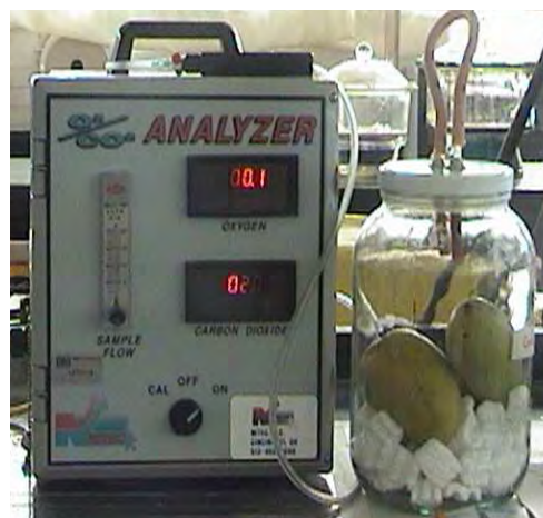
Figura 18. Determinación de la respiración con analizador de gas.
