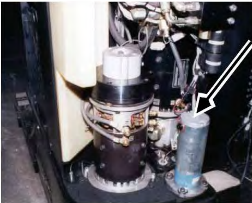
Foto 3-1. Posición de los motores de tracción y de dirección del Montacargas RDX30.
