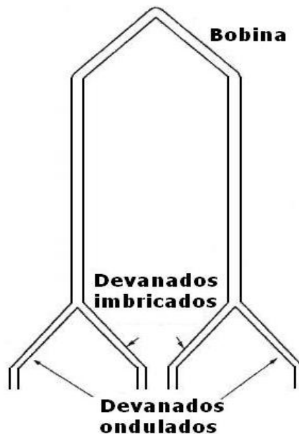
Figura 1-38. Bobina de un devanado pata de rana o autocompensador.
