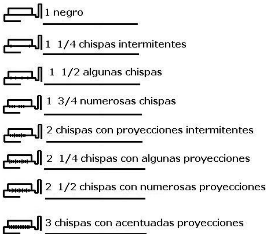
Figura 4-2. Niveles de chispazos en la conmutación.
